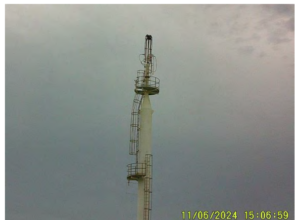
ภาพที่ 2.2-4 หอเผาทิ้งเหนือระดับพื้นดิน (Elevated Flare)
